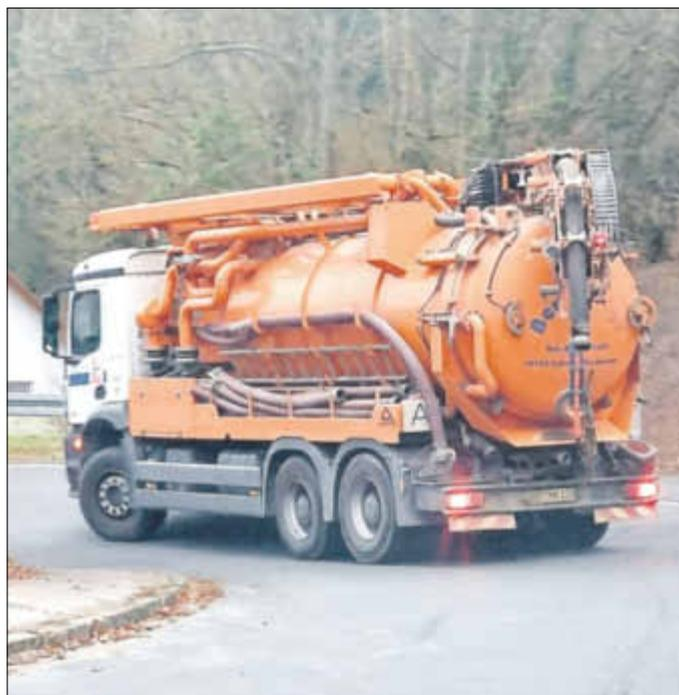
Vielleicht haben Sie in letzter Zeit in der Amöneburger Kernstadt immer wieder mal ein solches Kanalspülfahrzeug sowie weitere Kanalinspektionsfahrzeuge gesehen. Das liegt daran, dass derzeit die Kanalbefahrung bzw. die TV-Inspektion der Abwasserkanäle in der Kernstadt durchgeführt wird. Dies ist eine gesetzliche Pflichtaufgabe der Stadt als Betreiberin der Abwasserentsorgung, die in regelmäßigen Abständen zu erledigen ist.
