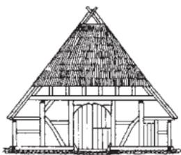
**NIEDERDEUTSCHES FACHWERK** wird von Zwei- und Vierständerkonstruktionen für große Hallenhäuser, mit einer direkt von der Straße zugänglichen zentralen Halle, der Diele geprägt. Der Grundriss dieser Häuser ist dreischiffig. Ursprünglich waren bei diesem
